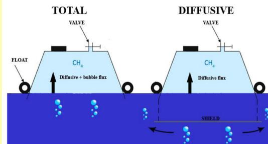
Fig. 2. The scheme of the «floating chambers».
